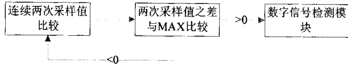
图 4.6 基于信号幅度特征的时域滤波算法示意图
