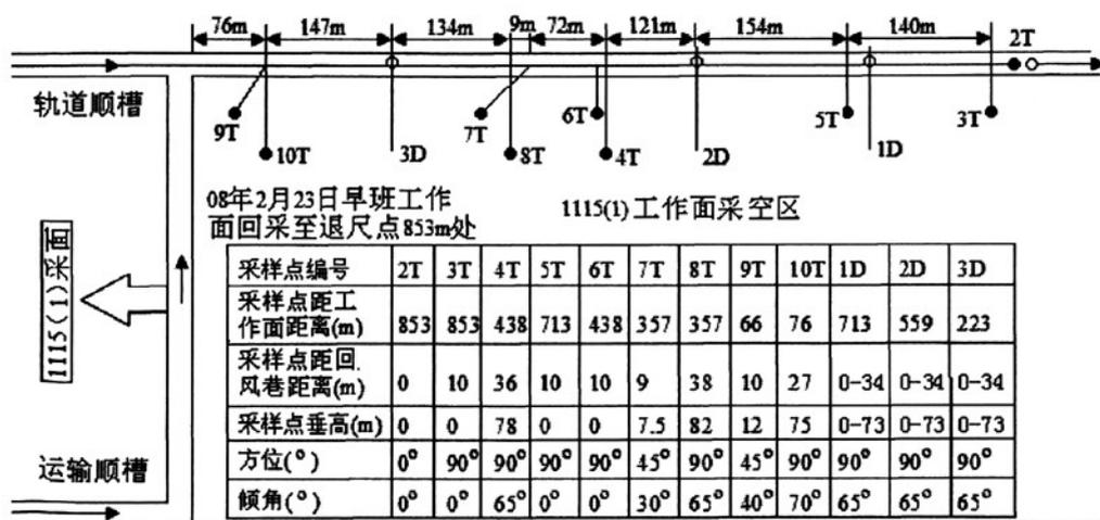
图 31 采空区沿空留巷一侧束管采样点位置图
