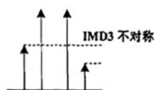
图 2-10 双音测试时 IMD3 不对称的现象
