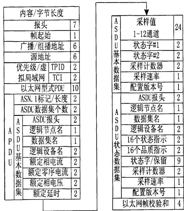
图 2-7 IEC 61850-9-1 定义 SAV 报文的以太网帧格式
