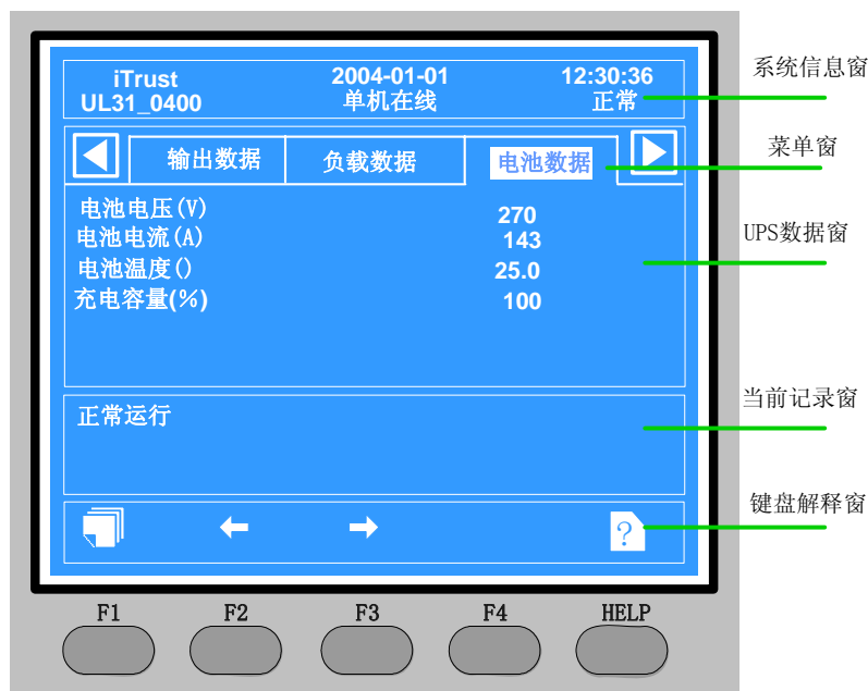
图 4-2 LCD 显示界面划分
