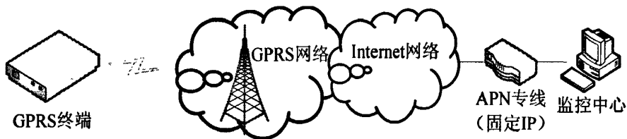
图 3.27 GPRS 组网方式三网络拓扑图
