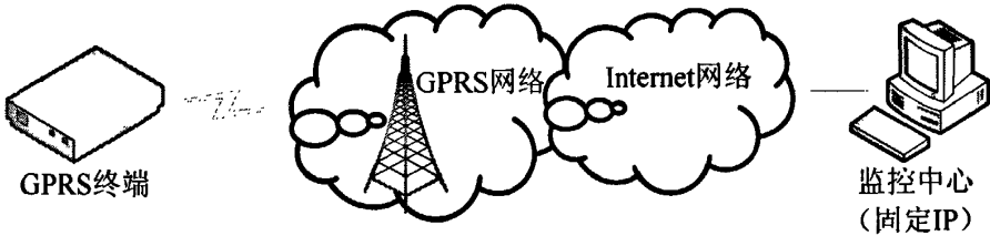
图 3.25 GPRS 组网方式一网络拓扑图
