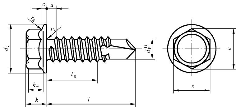
1) 钻头部分(直径  $d_p$ )的工作性能按 GB/T 3098.11 规定。
