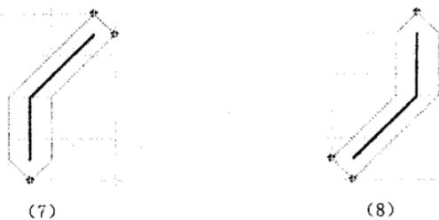
图 5.6 几种基本线型的绕障点
