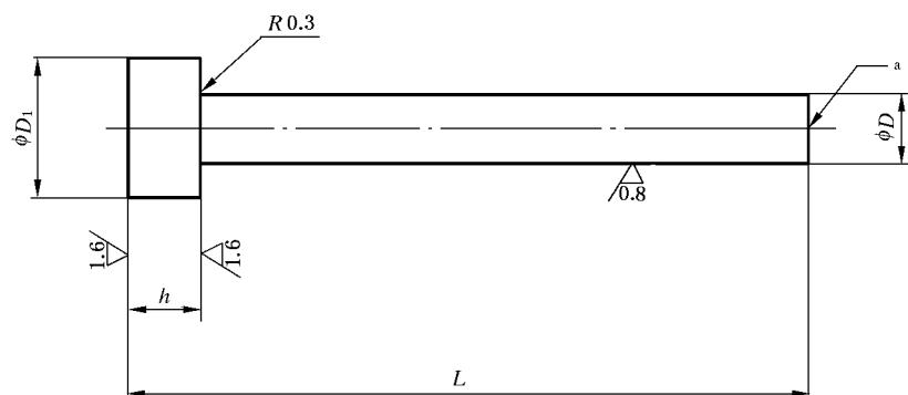
未注表面粗糙度  $R_a = 6.3 \mu\text{m}$ 。
