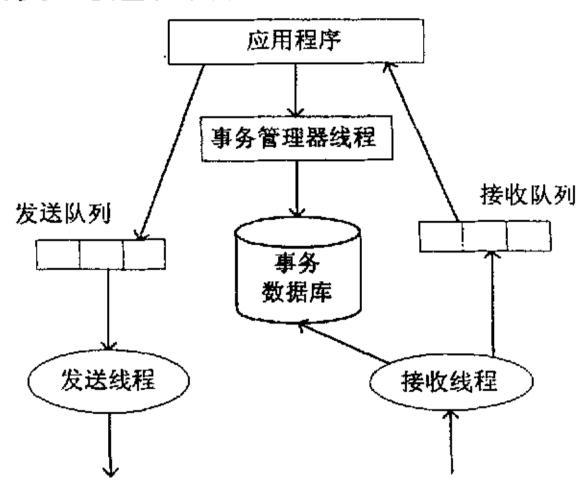
图3-5 SIP协议栈线程交互模型
