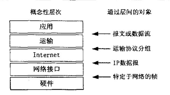
图2-3 TCP/IP的五层参考模型
