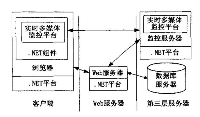
图3-9 三层结构的实时多媒体监控系统 结构图
