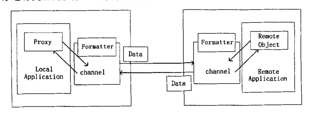
图2-4 .NET Remoting 框架结构
