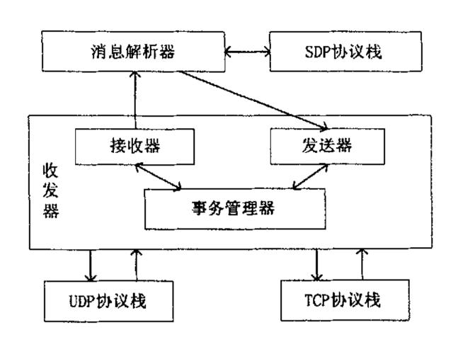
图3-4 SIP协议栈的组成
