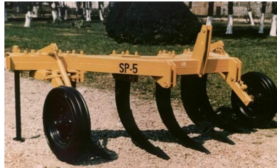
Fig. 10 - Subsoliierul purtat SP-3(5) echipat cu 3 / 5 organe active [1]
