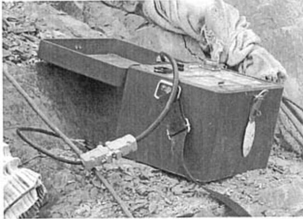
图 4-3 JMZX-3006 智能振弦数码检测仪
