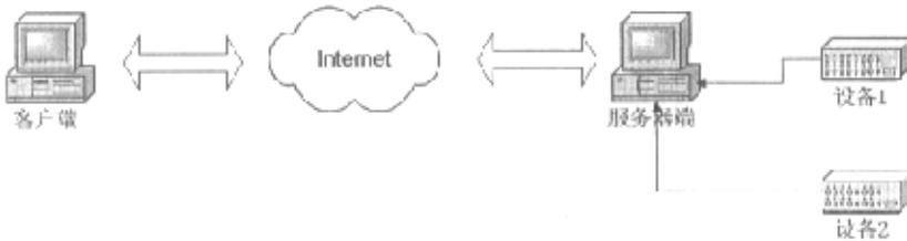
图 2.2 设备直接连接到前置计算机的 I/O 端口
