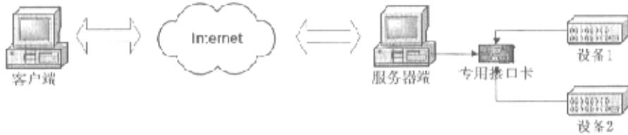
图 2.3 设备通过专用接口卡与前置 PC 机连接
