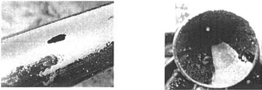
图 4-1 营 12-203 井原井油管磨损图
