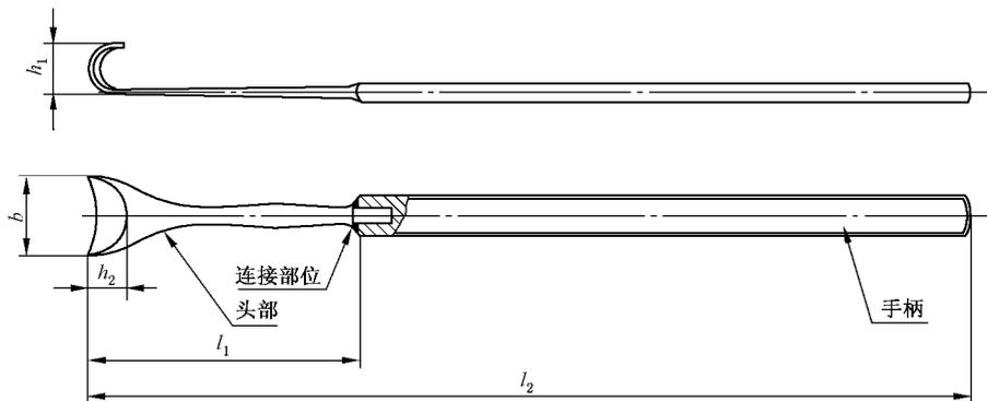
图 1 拉钩结构型式
