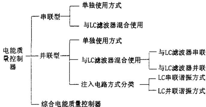
图 2.1 电能质量控制器的构成分类
