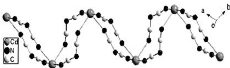
图 2-7 配合物(3)的由 [N(CN)_2] 桥连相邻两个 Cd(II)所形成的一维链状结构
