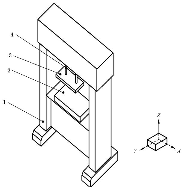
图 1 电解去毛刺机床
