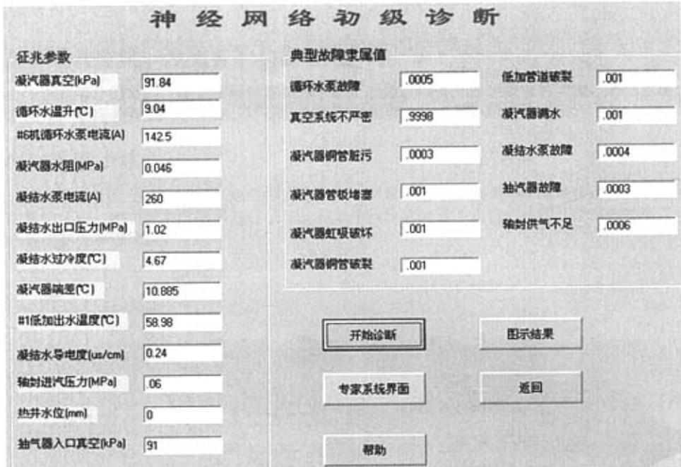
图 5-18 神经网络初级诊断征兆值和故障隶属值分布
