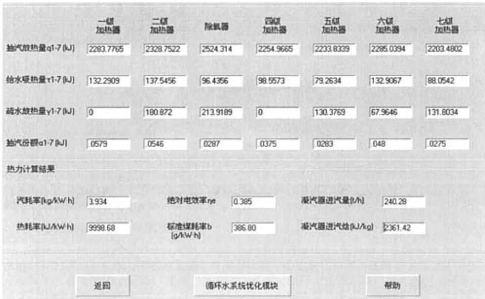
图 5-7 汽轮机组热力系统计算结果
