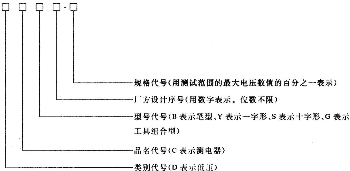
例：DCY111-5 表示工厂设计序号为 111 的一字形螺钉旋具低压测电器，规格为 100~500V。
