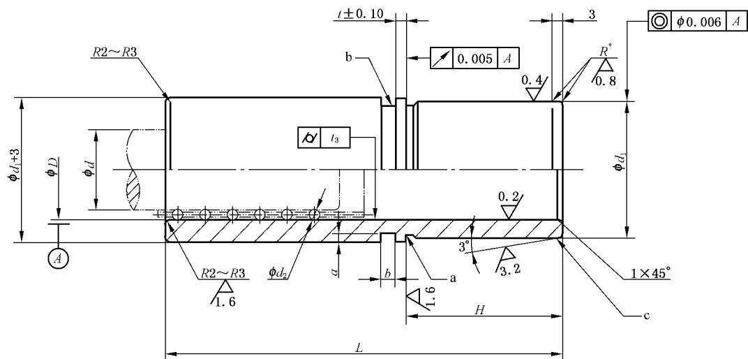
未注表面粗糙度  $R_a 6.3 \mu\text{m}$ 。
