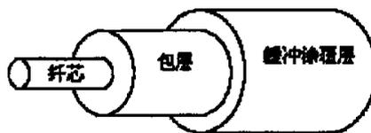
图2-1-1 单根光纤结构简图
