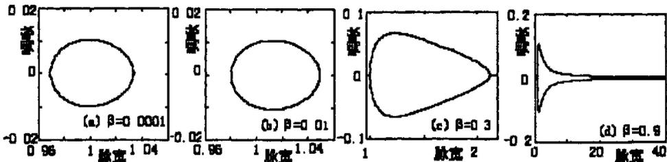
图 3-4-1  $b_0 = 0.1$  时孤子啁啾与脉宽之间的关系. (a)  $\beta=0.0001$ , (b)  $\beta=0.01$ , (c)  $\beta=0.3$ , (d)  $\beta=0.9$
