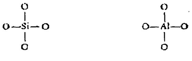
$TO_4$  四面体通过顶点的氧原子互相联结，形成花样繁多的二级结构单元，各种二级结构单元按照不同的排列方式能够组装了不同的沸石骨架结构。在此组装过程中，二级结构单元往往能组成新的更大的孔笼。每个孔笼又通过多元环窗口与其它孔笼相通，在沸石晶体内部孔笼之间形成了许多通道，称之为孔道。沸石主孔笼的最大多元环窗口尺寸通常成为该沸石的孔径。不同的沸石孔径大小不同，孔道形状亦不同，孔道体系的维数也有差别。
