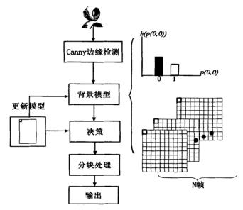
图 2.1 前景运动目标检测方法流程图
