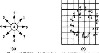
图 3.1 链码描述; (a) 绝对方向; (b) 链码描述, "\*"表示拐点 Fig 3.1 Chain code representation;
