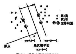
图 5.3 最优分类超平面示例 Fig. 5.3 The optimal hyperplane
