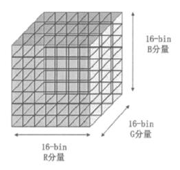
图 4.6 16×16×16-bin 直方图的 3D 视图表示 Fig.4.6 3D view of the 16×16-bin histogram
