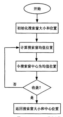
图 4.5 Mean Shift 算法流程
