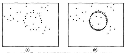
图 3.3 拟合圆图: (a)带有异常数据的圆; (b)拟合后的圆(粉红色)
