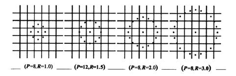
图 4.2 扩展的 LBP 图例 Fig. 4.2 Extended LBP operators
