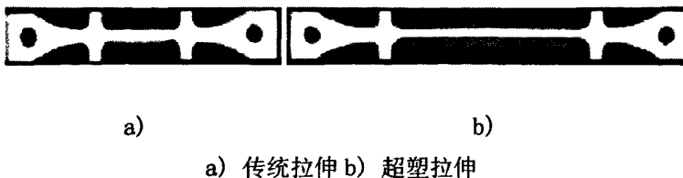
图 1-1 铝试样传统拉伸和超塑拉伸对比图
