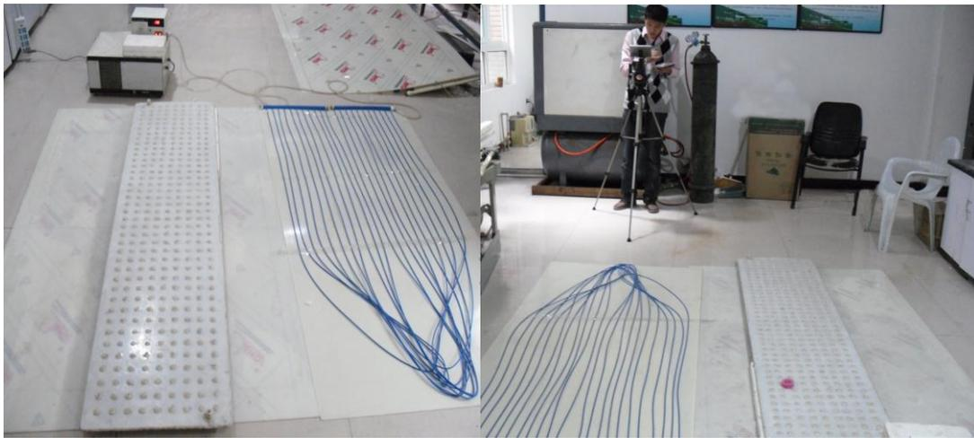
图 3.15 辐射板表面温度场测试图
