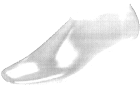
图 4.9 鞋楦 3D 自由曲面模型
