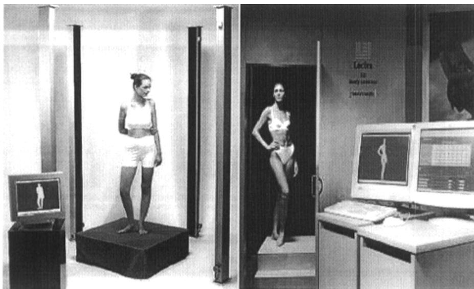
图 3.1 Vitus 非接触式三维人体扫描仪
