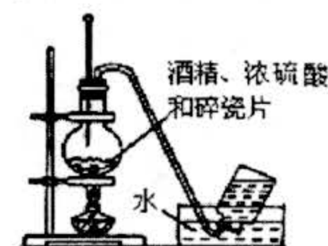
A. 实验室用乙醇制取乙烯
