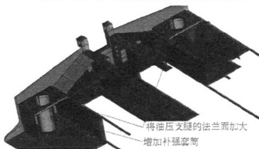
图 5-13 支腿部分结构修改图
