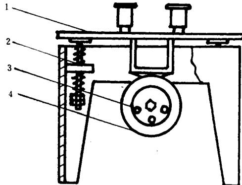
图 1 胶砂振动台
