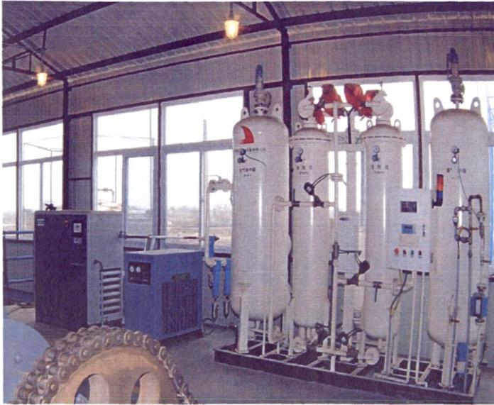
图 4-5 氧气发生装置
