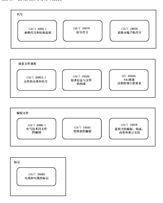
图 1 关于系统代号、文件编制和信息表达的标准概略图
