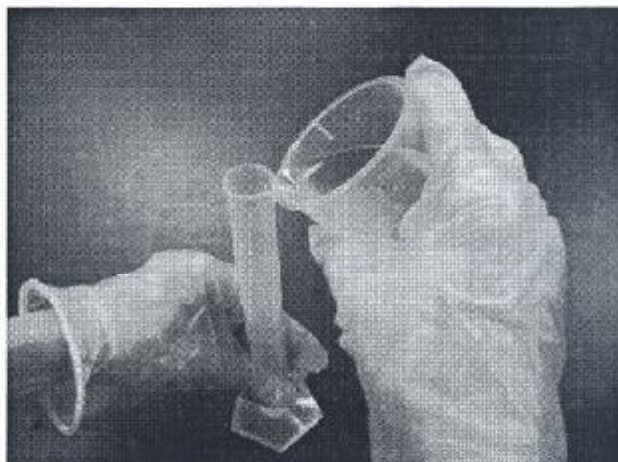
图 10.18: 水溶性盐的半定量测试——在标有刻度的圆筒内测量水
