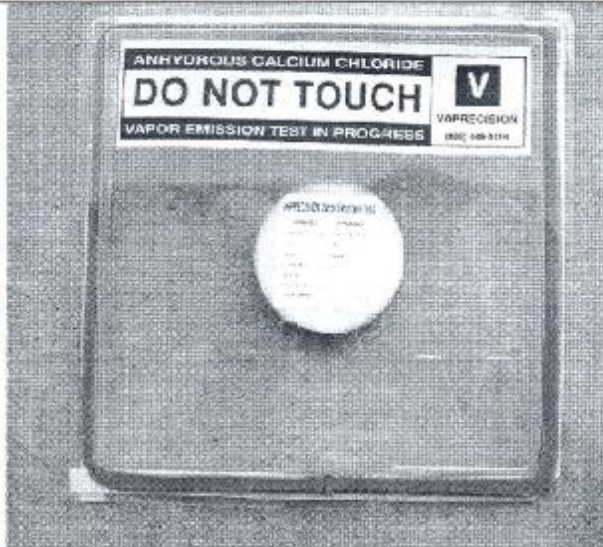
图 10.15: 混凝土地板上氯化钙水蒸汽释放测试
