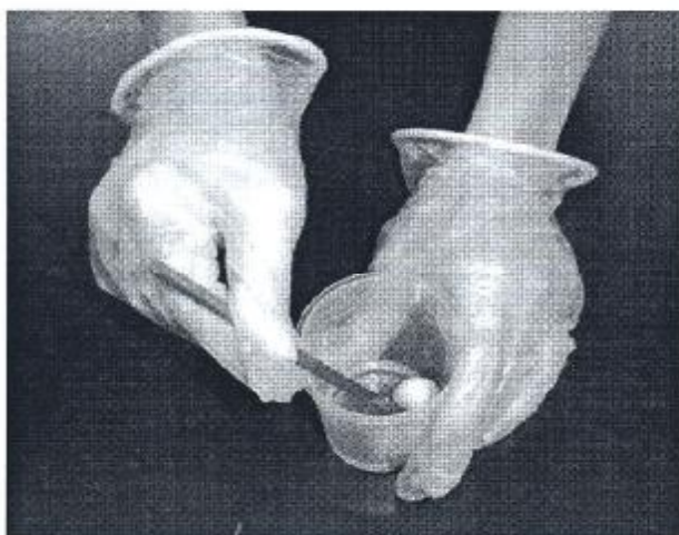
图 10.20: 水溶性盐的半定量测试——将大口杯内的东西搅拌 20 秒
