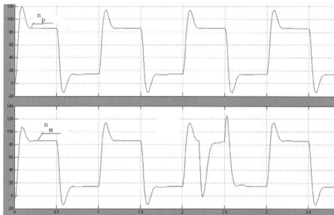
图 4-14 突加 20% 额定负载时，不采用自适应系统的速度阶跃响应
