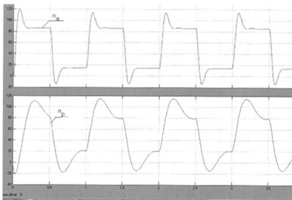
图 4-12 转动惯量为 1/3 时，不采用自适应方案的系统速度阶跃响应
