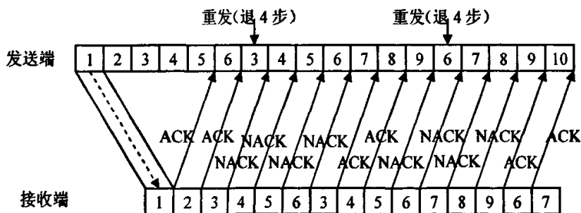
图 2.3 退回 N 步自动重传请求示意图
