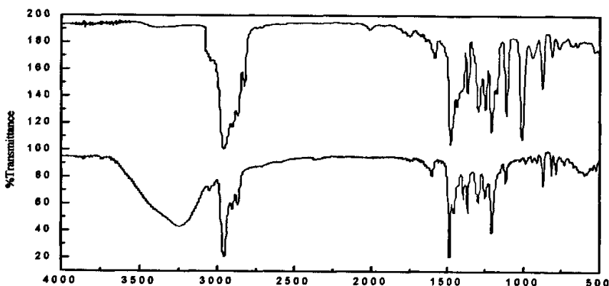
图 2-5 对叔丁基杯[8]芳烃及对叔丁基杯[8]芳烃甲基醚的红外图
