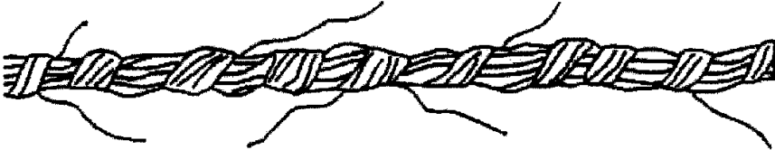
图 5.6 MJS 纱线结构模拟图
