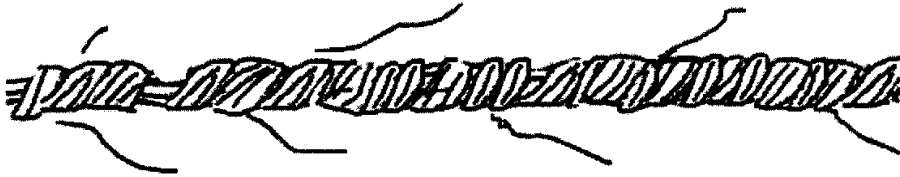
图 5.6 MVS 纱线结构模拟图
