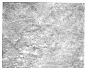
图 3-21 裂纹界面腐蚀产物
