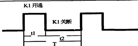
图 3.5 单极性脉冲电压输出的脉冲电压波形
