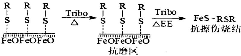
图 1-1 硫系添加剂作用机理模式图
