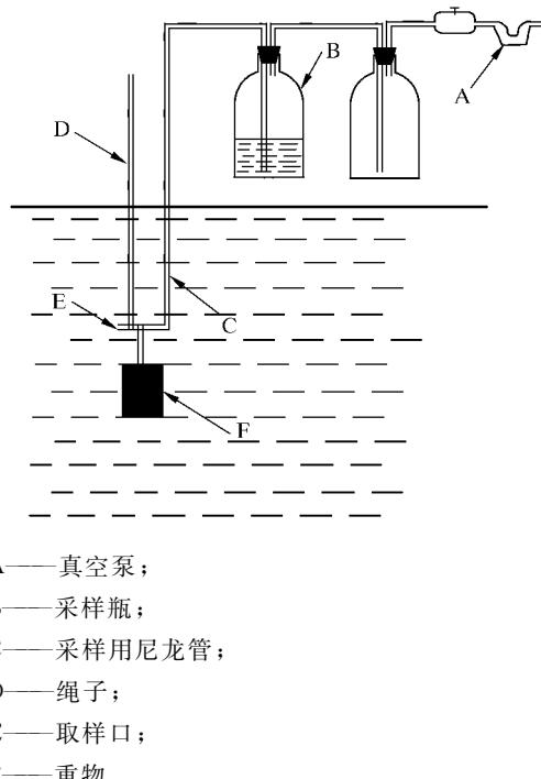
图 2 泵式取样器
