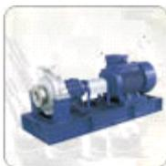
KZE 型石油化工用离心式流程泵，是根据 API610 规范设计制造的单级单吸离心泵。本系列泵适用于输送清洁或稍有污染且不含固体颗粒的中性或稍有腐蚀的液体，不适用输送强腐蚀液体，如需要这类泵，可选我公司的 KCZ 型化工流程泵。该系列泵主要用于炼油、石油化工、化学工业、煤加工工业、造纸工业、海洋工业、电业工业、食品、制药、环保等各种行业。
