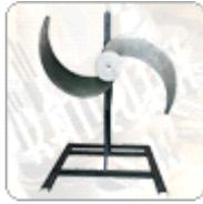
凯泉 WJ 系列潜水搅拌机是在充分研究国内外潜水搅拌机技术以及市场需求的基础上开发的，该系列潜水搅拌机流量200m<sup>3</sup>/h~3000m<sup>3</sup>/h，扬程0.4m~1m，功率0.75kW~18.5kW，叶轮直径200mm~766mm，转速360r/min~1420r/min，可潜入水下40m。新一代潜水搅拌机更省、更稳、更可靠。
