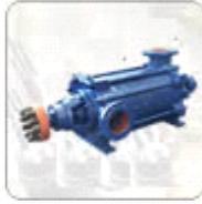
D 型卧式多级离心泵、MD 型煤矿用耐磨离心水泵是我公司根据市场需要而开发的系列产品。本产品具有结构紧凑、通用性强、可靠性高等优点，进出口方向可270度旋转，泵轴可以调换方向。D 型、MD 型泵具有相同的性能参数和安装尺寸。通过改变泵的材质可用于输送含磨料（颗粒）的介质。本产品符合 GB/T 5657-1995 《离心泵技术条件(III)》标准。MD 系列产品符合 MT114-1985 《煤矿用耐磨离心水泵》标准。
