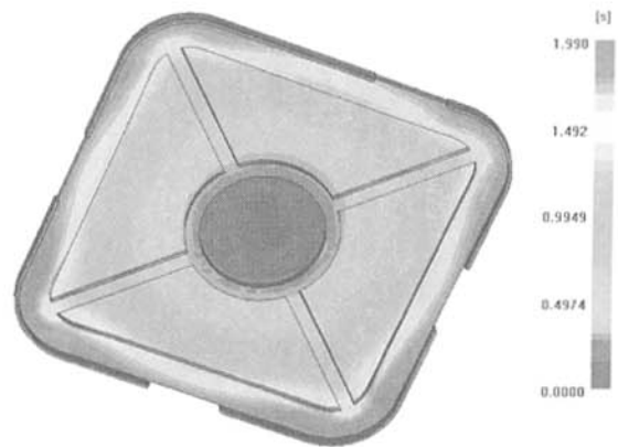
图 8 方案 3 的 Fill time 分析
