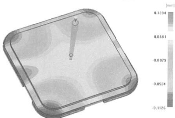
图 7 方案 2 的 Z 方向变形分析
