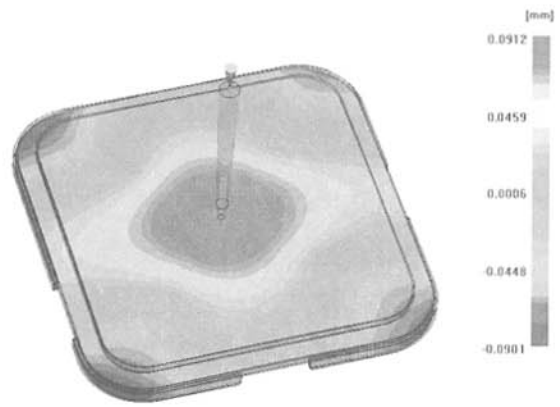
图 9 方案 3 的 Z 方向变形分析
