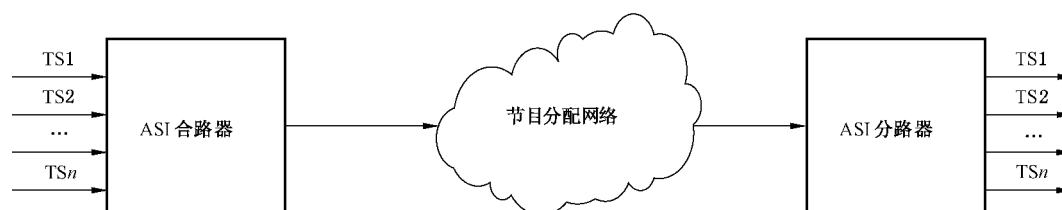
图 1 具有 ASI 合路/分路器的多路节目分配网络结构图
