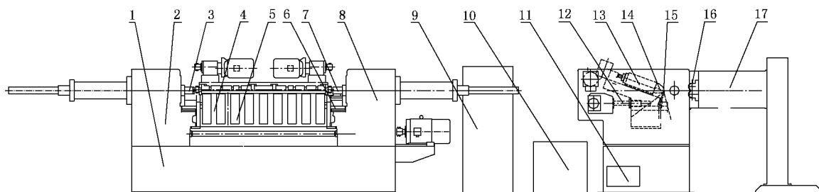
图1 旋切机结构简图
