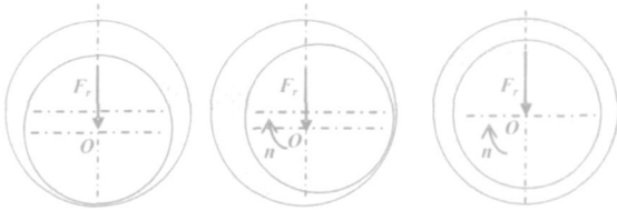
图 3 柱塞与缸体之间油膜润滑示意图
