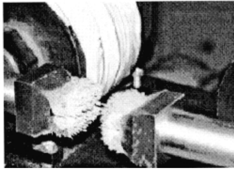
图 6-1 磁性磨料在磁场中形成的磁刷
