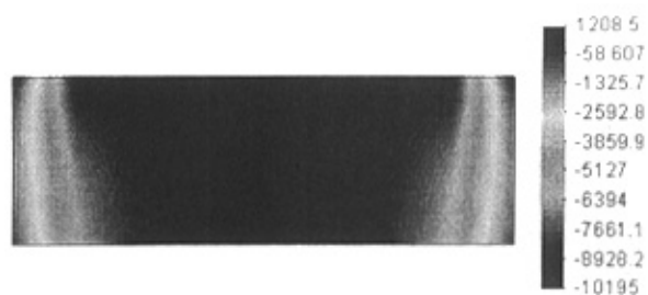
图 5-3 (4) 大变形正应力 \sigma_y 分布云图 (第 10 天) (M1)
