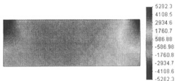
图 5-3 (6) 大变形剪应力 \tau_{xy} 分布云图 (第 10 天) (M1)
