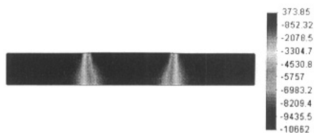
图 5-12 (4) 大变形正应力 \sigma_y 分布云图 (第 450 天) (M2)
